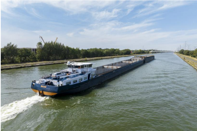
Foto: voorbeeld van een binnenvaartschip met hybride aandrijving met EST-Floattech's systeem
